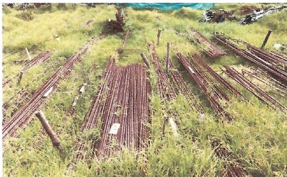
Varillas de refuerzo cubiertas de pasto y oxidadas
